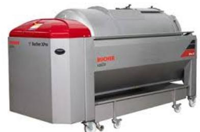
tanque. Las operaciones de prensado incluyen varios ciclos de incrementos de presión, entre los cuales el tambor gira para mezclar las uvas<sup>5</sup>.
