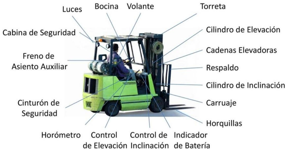
Figura A3.1 – Partes de un Montacargas<sup>3</sup>
