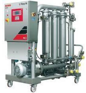
**Filtro de membrana** – El vino pasa por un cartucho compuesto de materiales como nylon, polipropileno, ésteres de celulosa o fibras de vidrio. Estos filtros pueden tener efecto sobre el aclarado. Se utilizan principalmente para la estabilización microbiana y, con frecuencia, es el último paso de filtración antes de embotellar los vinos<sup>23</sup>.
